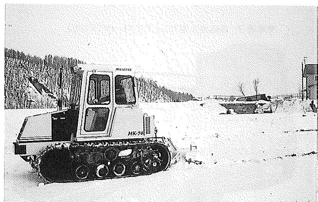
▲写真2 雪の上からの作業なので土を傷めず心土破碎できる
