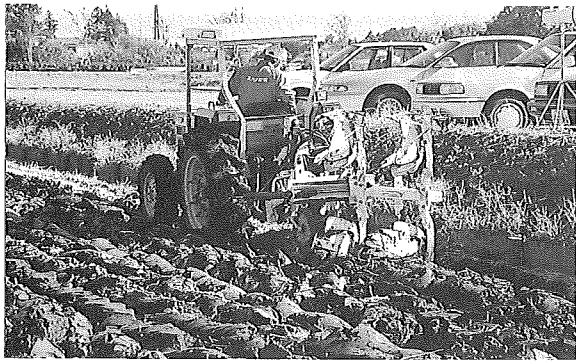
リバーシブルプラウによる稲ワラ鋤込み 完全に鋤込むことにより、地力向上だけでなく、 代かき時のワラが浮かず作業しやすくなる
