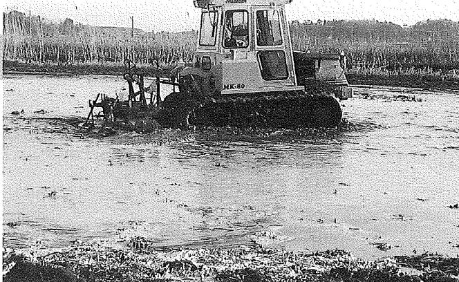
▲クローラトラクタを使った代かき作業。空回りによる泥のかき出しや、本機の沈み込みも全くなく、代かきが行える
