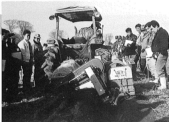
▲富士トレーラーの畦塗機による畦塗り作業。ヤンマーの畦塗り機とともに、乗用タイプである
