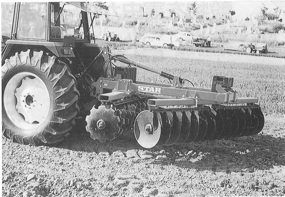
▲最近のデスクハロー（オフセット型） 中下層を鎮圧することに効果的である。前処理機としてもすぐれ、その後の仕上げ砕土・整地機の能率、精度を高めることに役立つ。小麦のワラ稈などを土中にすき込むことにも威力を発揮する
