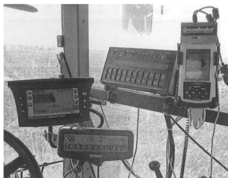
エヌ・テック社のグリーンシーカーRT200システムによって、生産物に必要な養分を常に分析しながら、適切な施肥作業を一体化して行なえるようになる。
