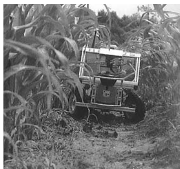
エドゥロ (Eduro) はチェコの製農業用ロボットの名前で、長さ45cm、高さ30cmという小型サイズだ。
