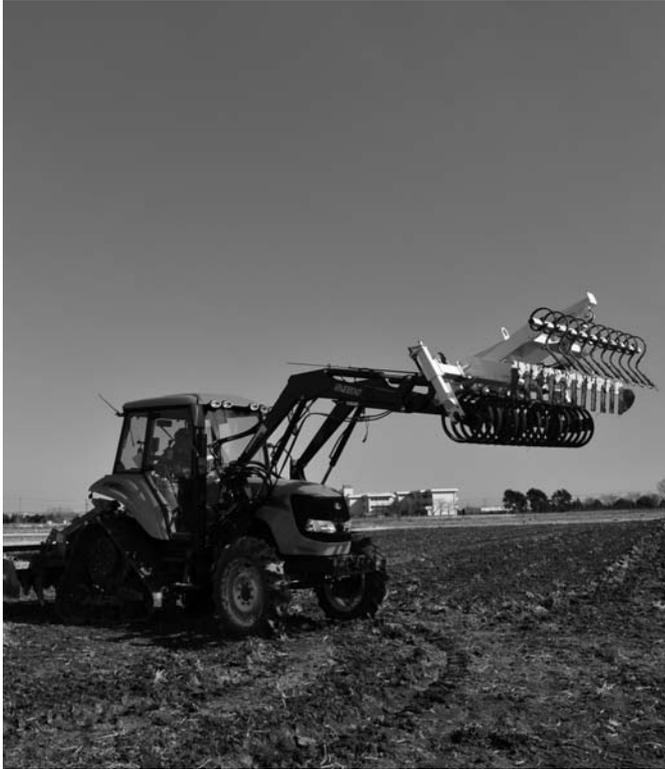
フロントローダを活用して砕土・整地作業を行なう「フロンティア ローダSS」。スガノ農機と三陽機器が共同開発した。写真のようにフロントローダを持ち上げることができるので、枕地での旋回も容易だ。2010年7月に発売予定。
