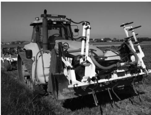
所有するには、組み立てられた折りたたみ式作業機で、砕土・整地を行なう。岐阜県のサンフレッシュ海津が所有するチャレンジャートラクターには、スガノ農機が初めて開発に取り組んだフロント作業機が装着されている。スプリングタインを採用した折りたたみ式作業機で、砕土・整地を行なう。
