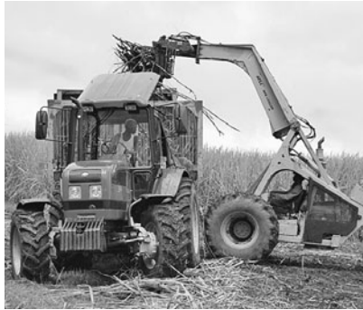
出力62kW/84hpのベラルーシ製トラクタ920.3型。南アフリカではサトウキビ運搬作業に投入されている。
