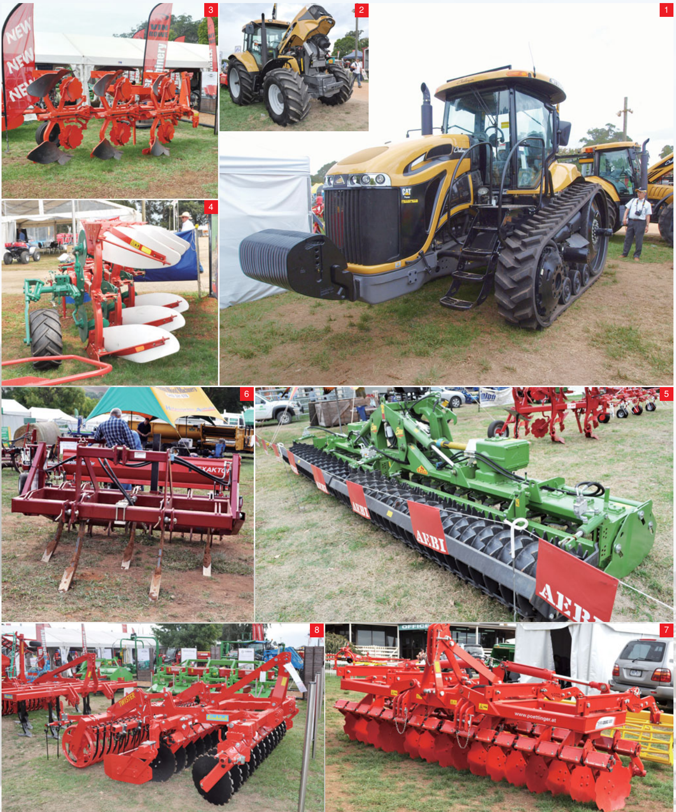
1 写真はゴムクローラトラクタの歴史を作ってきたチャレンジャー（米国AGCO社）のMT700Cシリーズ（エンジン馬力300～320hp）。展示者の話ではこの上の800Cシリーズ（同410～585ps）もよく売れていると話していた。ユーザーは穀類農家から野菜農家まで多様だそうだ。2 これもチャレンジャーのホイールタイプMT600Cシリーズ。写真の機械は240psのものだが、同シリーズには320psまであり、MT900シリーズでは440～585psまでのバラエティがある（エンジン馬力300～320hp）。3 4 オーストラリアでもプラウが復活しているようだ。写真は総合作業機メーカーであるクバナランド（ノルウェー）のプラウ。3 はスチールタイプだが、4 はプラスチック板を張り付けたものではなく、ボトム全体がプラスチック製のプラウ。水稲が作られていたような粘土地帯で使われているという。5 碎土整地機はこうした作業幅の広いリングローラを付けたタイプが多く出されていたが、機械による踏圧の害を避けるために複合型の碎土整地機が目立った。6 スガノのプラソイラに似たチゼルに碎土用のツースハローを組み合わせた機械。7 花形のディスクハローに回転爪とカゴローターを組み合わせたもの。移動時は油圧で二つに折れ曲がる。8 二列の形状の違うディスクハローに前後を棒状のハローで挟まれたカゴローターを付けた碎土整地機。
