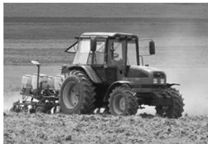
不耕起農法用の播種機なら、家畜が踏み固めた土地でも播種できる。
