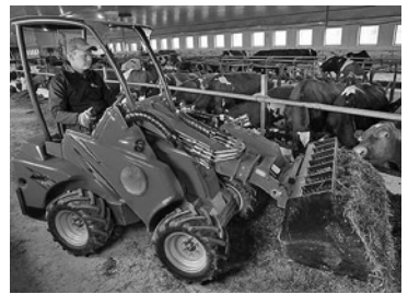
アヴァント社のローダー新機種420型は、長さ2.2mで車高1m、重量は1tとなっている。
