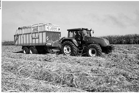
ウボンボの製糖工場ではサトウキビ残さを集めるためにポッティンガー社製ジャンボ6600型（右）とクラス社製ラウンド・ベラー（上）を使用している。
