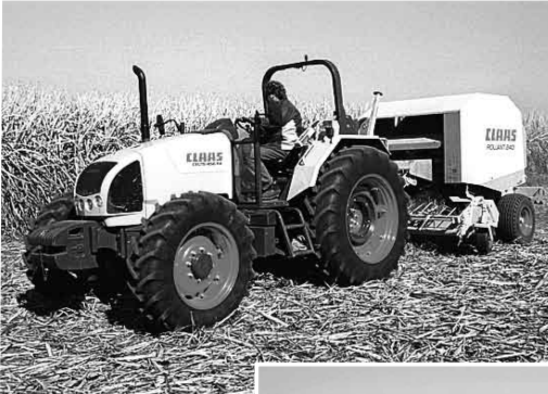
ウボンボの製糖工場ではサトウキビ残さを集めるためにポッティンガー社製ジャンボ6600型（右）とクラス社製ラウンド・ベラー（上）を使用している。
