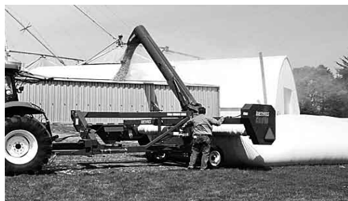
ミネソタ州のロフトネス社が開発したグレイン・バッグ・システム。長大なバッグと、充填機と、取り出し装置の3つで構成される。バッグに穀物を詰め込むのが充填機、取り出し装置はそれを逆に吸い出す。
