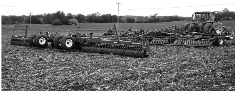
ブリリオン社製、ウイング・フロート形式の碎土鎮圧機。左右のウイングが独立して動き、ドリルによる播種作業の前に地表の凹凸を減らし、均一の播種床を作る。
