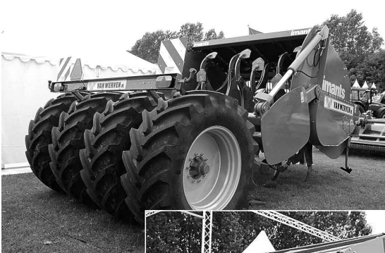
イマンツ社による特製の深耕ロータリ。幅3m、深さ135cmの土を掘り起こすことができる。
