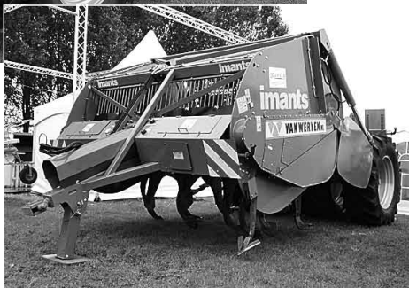
イマンツ社による特製の深耕ロータリ。幅3m、深さ135cmの土を掘り起こすことができる。
