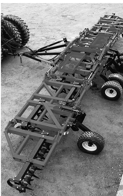
ジェネシス・ティレージ社製、Gen-Till IIエアレータ。ツメ部分は熟処理加工されている。
