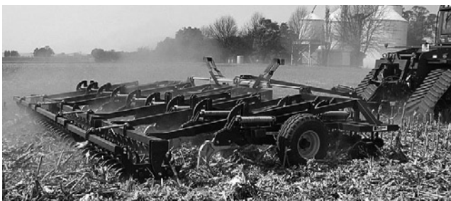
ディスクプラウと、交互に動くスタンプジャンパーのチゼル爪とツイン・ローラー爪を搭載した巨大なコンボ・リッパは深さ50cmまで耕することができる。
