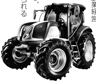
水素利用式燃料電池を搭載したニューホランド社製の実験的なNH2型トラクターは、CNHグローバル社が研究資金を投じて見据える未来を示している。
