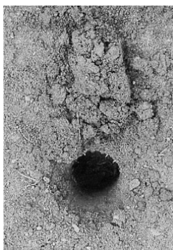
▲3 ゆっくり回転させながら引き上げると穴の周囲が崩れず、きれいな穴があげられる
