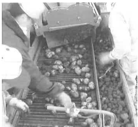
機上にはイモと土石とが分離されて運ばれてくる
