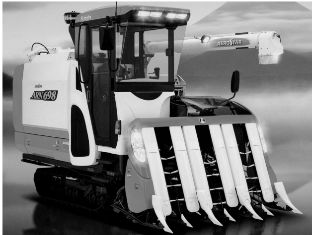
大排気量直噴ディーゼルエンジンを搭載した6条刈コンバインは、基本性能の充実もさることながら、作業灯やキャビンにも工夫を凝らしている。
