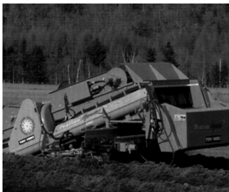
セパレータ：石や土塊の除去に。セパレートされた石・礫は渠に排出する
