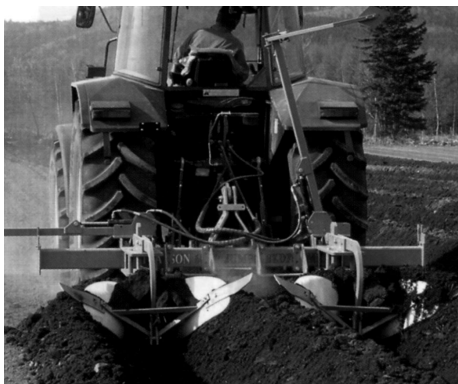
ベッドフォーマ：2畦分の土寄せに絶大な能力を発揮。サブソイラ作業も同時に行い排水性もアップ
