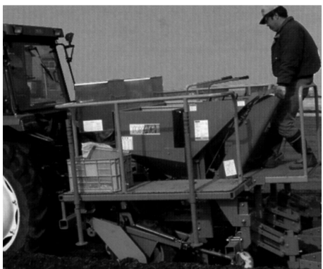
深植ポテトプランタ：種芋の植付けに最適。慣行法より深植することで、芋の緑化や培土時のトラクタの踏圧を防ぐ
