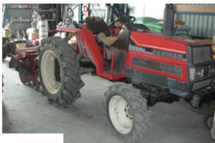
①ロータリカルチ（松山株「RM-212M」）西村氏の麦作の畝幅は130cm。カルチで土寄せする際、トラクタが通常の車幅では畝の肩を踏みつけてしまう。そのため、写真②③にあるようにトラクタのリアアックスルを40cmほど延長した。注目は、車軸を伸ばすのではなく、ホイールとディスクの間にマス状の鉄板を挟んでいること。そして、ディスクを反対に取り付け長さを稼いでいること。これなら「最低限の手間で改造できる。発想の転換」と西村氏。実際に畝をまたいで作業している様子は写真④。麦作は、除草や分けつ
