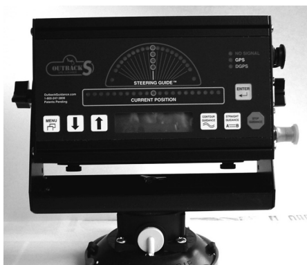
ディスプレイボード。画面上にある扇形のステアリングガイドを見ながらハンドルを切るだけでいい
