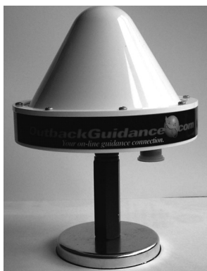
GPS受信アンテナ。これでGPS衛星から電波を受信し、トラクタの位置を把握する
