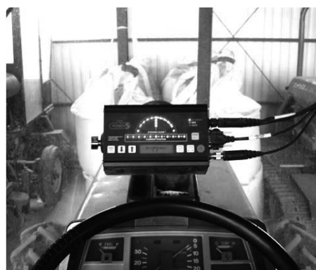
フロントガラスの手に装着されたディスプレイボード。ステアリングガイドを見ながら前を向いて作業できる
