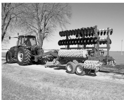
移動に便利な折畳みシステムは、1分間で作業モードから移動モードへ切換えることができる。移動時の作業機幅は2.5m。
