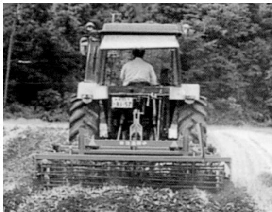
有機物の混和などに効果を発揮する。時速8kmと作業能率が高い
