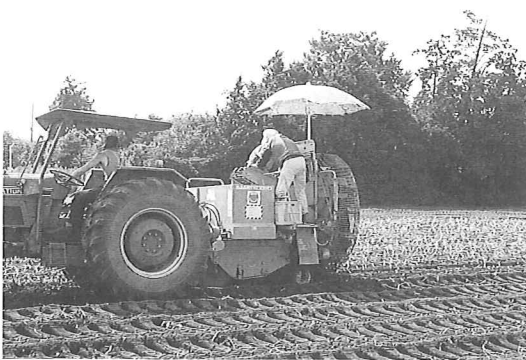
トラクタ直装タイプのビートハーベスタでの収穫。規格外品の扱以外に人力運搬はない作業体系だ
