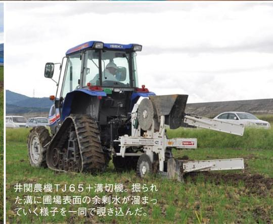
井関農機TJ65+溝切機。掘られた溝に圃場表面の余剰水が溜まっていく様子を一同で覗き込んだ。
