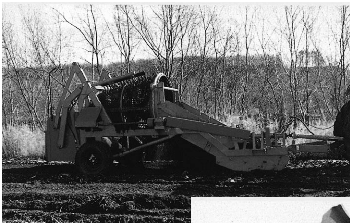
後方ダンプ方式のストーンピッカー、SST-1100A。回転ドラムを備え、石れきと土の分離が効率良く行なえるようになっている。作業幅：110～120cm、最大掘り取り深さ：40cm、タンク容量：1㎡、バケットの高さ：2m、装着方法：ロアリンク2点装着式、適応トラクター：70馬力以上。北海道価格は5,250,000円（税込、送料別途）。
