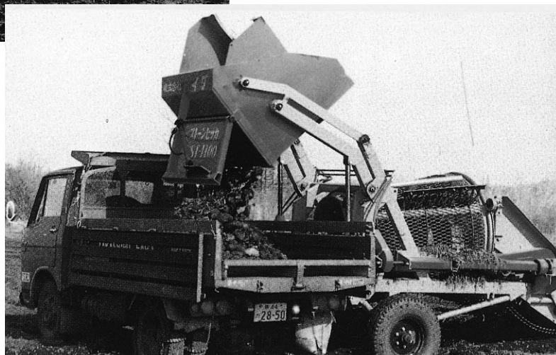
後方ダンプ方式のストーンピッカー、SST-1100A。回転ドラムを備え、石れきと土の分離が効率良く行なえるようになっている。作業幅：110～120cm、最大掘り取り深さ：40cm、タンク容量：1㎡、バケットの高さ：2m、装着方法：ロアリンク2点装着式、適応トラクター：70馬力以上。北海道価格は5,250,000円（税込、送料別途）。
