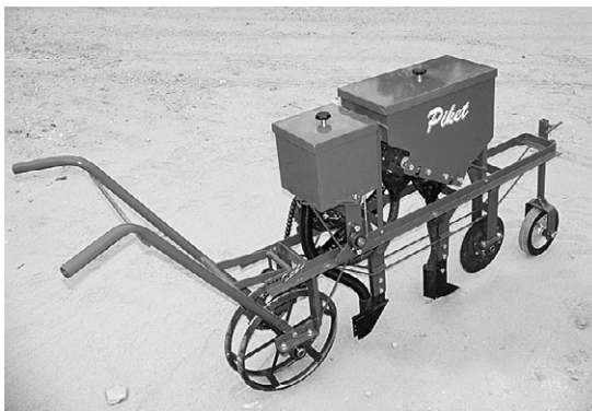
前部に設置された16mm幅のすき用の刃が最小限度でかく押し、アフリカの不耕起栽培に不可欠な水のろ過機能を向上させる。28mm幅の靴型をした播き溝を作る部分は最適な播種作業用に調節が可能になっている。
