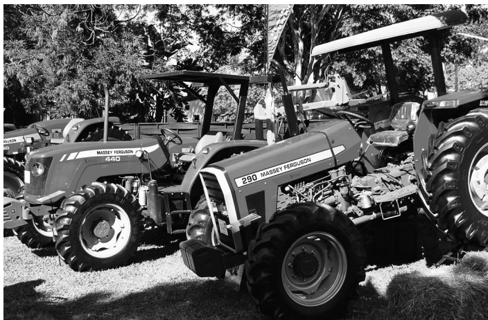
ブラジルで組み立てられたMF440Xtraとインドで製造されたMF290モデルは異なったスタイリングであるが、両方とも定格出力は80馬力である。
