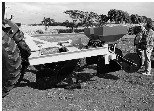
肥料用ホッパーおよび畝立て機能を追加したことにより、この試作機では1回で土壌調整とサトウキビの植え替えを行なうことが可能になった。
