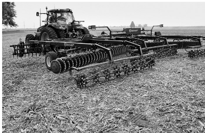
アースマスター社のVerti-Goは、作物残さを刈り取り、土壌水分を保持して均一に植え付けるための整地用に設計された垂直方向耕うん機である。
