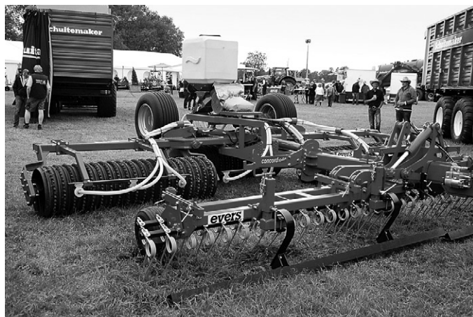
オランダ製のEvers社 Grass-Profi機は牧草の生育を向上させる単一動作での草地再生機として販売されている。この製品の後ろにはSchuitemaker社の最新型Rapide (製品名) 両用トレーラーワゴンが用意されている。
