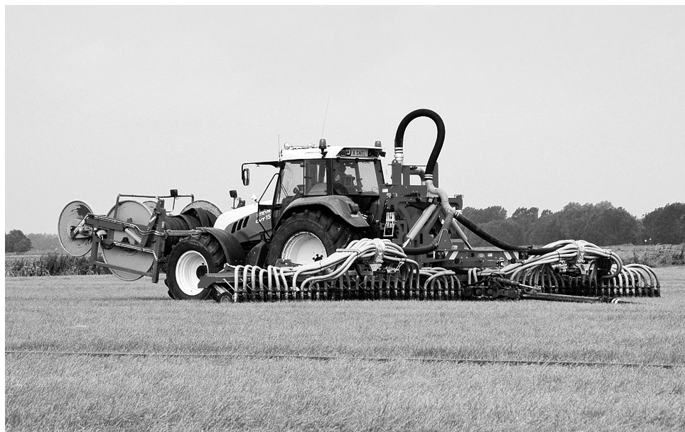
Schouten社のスパイダーは供給パイプ機構またはスラリータンカーに直接搭載する両方の方法で利用可能である。ディスクの直径は35cmであり、個別のインジェクタユニットはゴム製のサスペンションとともにパラレルアームに設置されている。
