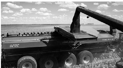
50tのオステック製貯蔵車は12m幅の3つのヘッダーの処理量に遅れずに伴走し、4t/haのソルガムを収穫する。
