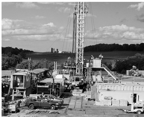
約0.5haが地表部でのわずかな破壊を想定して採掘リグ用に確保されている。垂直方向の採掘は深さ1.6~2.4kmまで下降し、水平方法へは大体同じ距離まで採掘される。ガス井周辺の土地では引き続き農業生産を継続できる。
