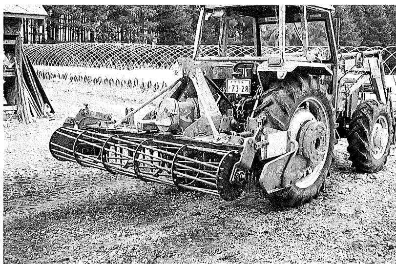
写真4 ケージローラ付き縦軸型ロータリーハロー スパイクが高速で回転し、碎土する。構造上、深く碎土することはできないが、表層の仕上がりはよい。後部のケージローラが中層をしっかりと鎮圧し、理想的な播種床を造成する
