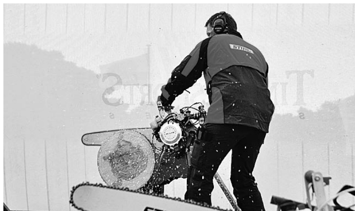
F1クラスのカutting・パフォーマンスでは、スチール社のティンバースポーツチームは65馬力、回転速度325km/hのロターリーエンジン仕様のチェーンソーを駆使する。
