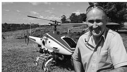
ヤマハのリアム・キグリー氏によると、同社のRmax無人ヘリコプターは2つのノズルを使って7m幅で散布を行なう。同機の散布能力は6分間で0.08haをカバーする。
