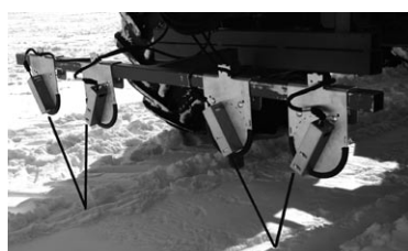
図1 トラクタ前面のブラケットに取り付けたソニックセンサ。 ※ラインは検出するイメージで実際には見えません。
