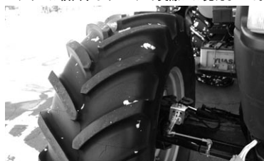
図2 前輪の車軸に取り付けられた制御装置。信号にすばやく対応する。
