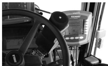
図3 トラクタのキャビン内に設置されてモニターとハンドルの操舵機構。
