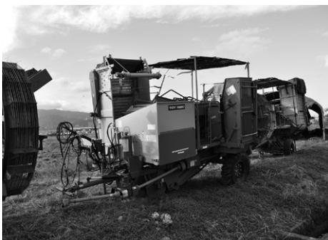
東洋農機製のジャガイモ用ハーベスタ。生産開始から1~2年で導入。仲間で共同所有し、1台ずつ管理担当を決めてメンテナンスを行なう。
