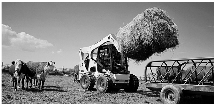
スキッドステアローダーは米国農家に人気がある。掘る、押す、ならすなど作業もこなせる汎用機だ。写真の9馬力エンジンのボブキャットS770は最大揚力1.5tで、垂直に3.35m持ち上げることができる。
