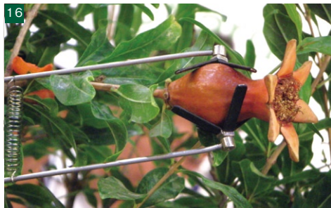
⑬⑭⑮可食部や幹の肥大をミクロン単位で測定するPhyTech社の作物センサー。栽培している作物の形状に合ったセンサーを選ぶ。ポイントは肥大と土壌水分の相関関係を見極めること。制御盤と水分計2本のセットで販売している。
