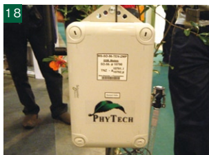
⑬⑭⑮可食部や幹の肥大をミクロン単位で測定するPhyTech社の作物センサー。栽培している作物の形状に合ったセンサーを選ぶ。ポイントは肥大と土壌水分の相関関係を見極めること。制御盤と水分計2本のセットで販売している。
