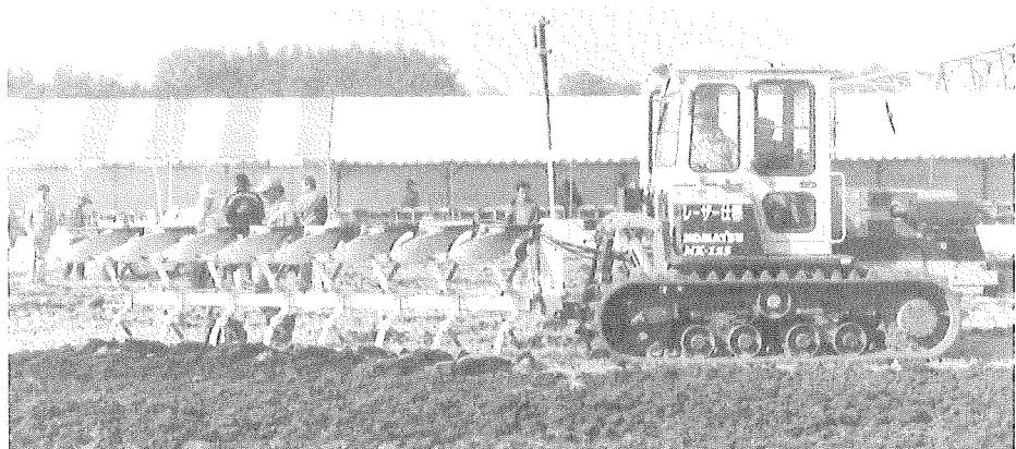
65 コマツゴムクローラトラクターMK-125（上）操作は2本レバーのHST。建機のノウハウを生かした頑丈さを誇る。写真のプラウはスガノの8連リバーシブル（RQY128PL）
