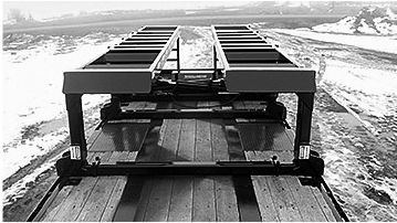
シヨルマイヤー社製の架台。ほとんどのメーカー・型式の高クリアランススプレイヤに対応可能。使用しない時は油圧操作でトレーラーの荷台の上に折り畳める。より詳しい商品情報はwww.schollmeyerengineering.comのサイトを参照のこと。
