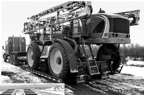
シヨルマイヤー社製の架台。ほとんどのメーカー・型式の高クリアランススプレイヤに対応可能。使用しない時は油圧操作でトレーラーの荷台の上に折り畳める。より詳しい商品情報はwww.schollmeyerengineering.comのサイトを参照のこと。
