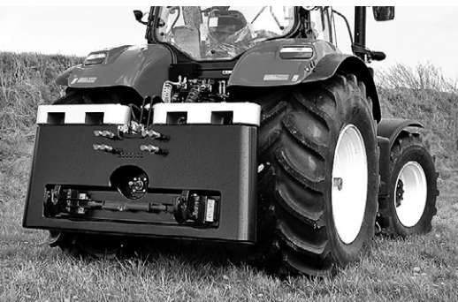
パテール社のピックアップの標準構成は重さ2,000kg。200kgのウエイトを4つまで付け足すことができる。写真はピックアップに取り付けられた2つの追加ウエイト。
