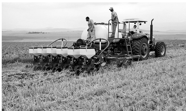
ティーボ・テック社の6条精密SL播種機は小麦の刈り跡に直接播種できる。8条・10条モデルのリリースも予定されている。（写真提供：ティーボ・テック社）
