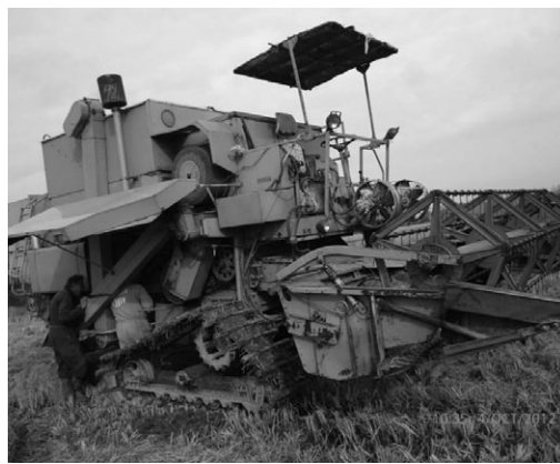
図8 1979年製のクラス社のコンバイン(刈幅:3.9m)
