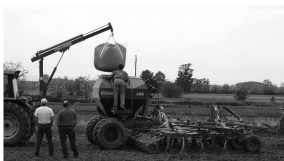
図10 イタリアの次世代の直播を担う、耕起から乾田条播までを一度に行なう装置。播種量は150kg/ha、500粒/m 2 にて密植する点是不変。
