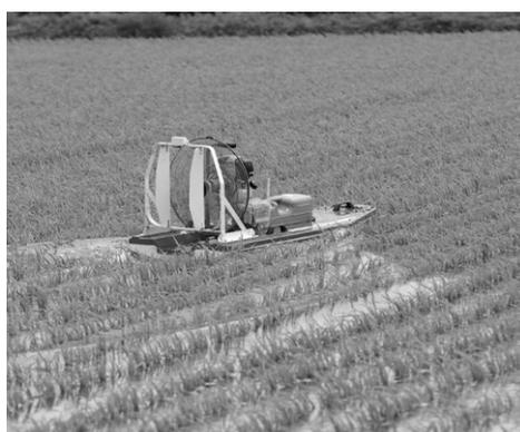
水田を走行し、散布作業中のラジコンボート。薬剤は水中に放出するので、飛散がなく、作業者にも安全で、ドリフトの心配もいらない。
