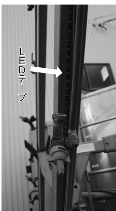
LEDテープを装着したブーム部分
