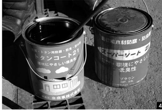
4 水が浸潤や腐植を防ぐためにトタンコート剤を試行錯誤している。木材保護材のキシラデコールの効果は確認しているが2度塗りするには高価で、原価が跳ね上がってしまうとか……。そこで、愛知県常滑地方ではコーラールが外壁に塗られていることからヒントを得て、防腐剤を2度塗りをした後、コーラールを塗る方法が現段階での最善の方法だという 5 電
