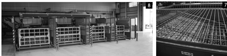
6 NICHOLSON 社製のタマネギ選別機「Onion Top-Tail T.T.1800」。写真左上から投入されたタマネギは葉切・根切部(7)を通った後、手選別部を通過して搬送され写真右上の選別部(8)でS・M・L・2Lの4段階に振り分ける。処理能力は8時間の稼働で最大100t。7らせん状の刃でタマネギの葉と根を切る。8選別部も大コン仕様。
