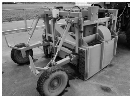
11 オニオンピッカーは訓子府工業製。山本社長曰く、「青果」に向かないものが「加工用」ではないので、歩留りの高い定品質のものを安定して出荷できることが重要とのこと。使っている大コンは約3,500個。
