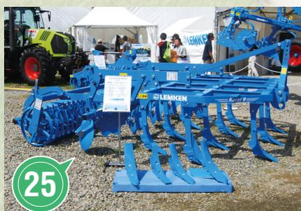
レムケン Karat9/300(株式会社LMJ)：最近、水田経営者が注目しているカルチベーター。®を同じく、ティンと花形ディスクの組み合わせ。写真の「カラット」はティンが3列だが、「クリスタル」は2列に配置されている。90PS～適応とあるが、十分なフロントウエイトが必要
