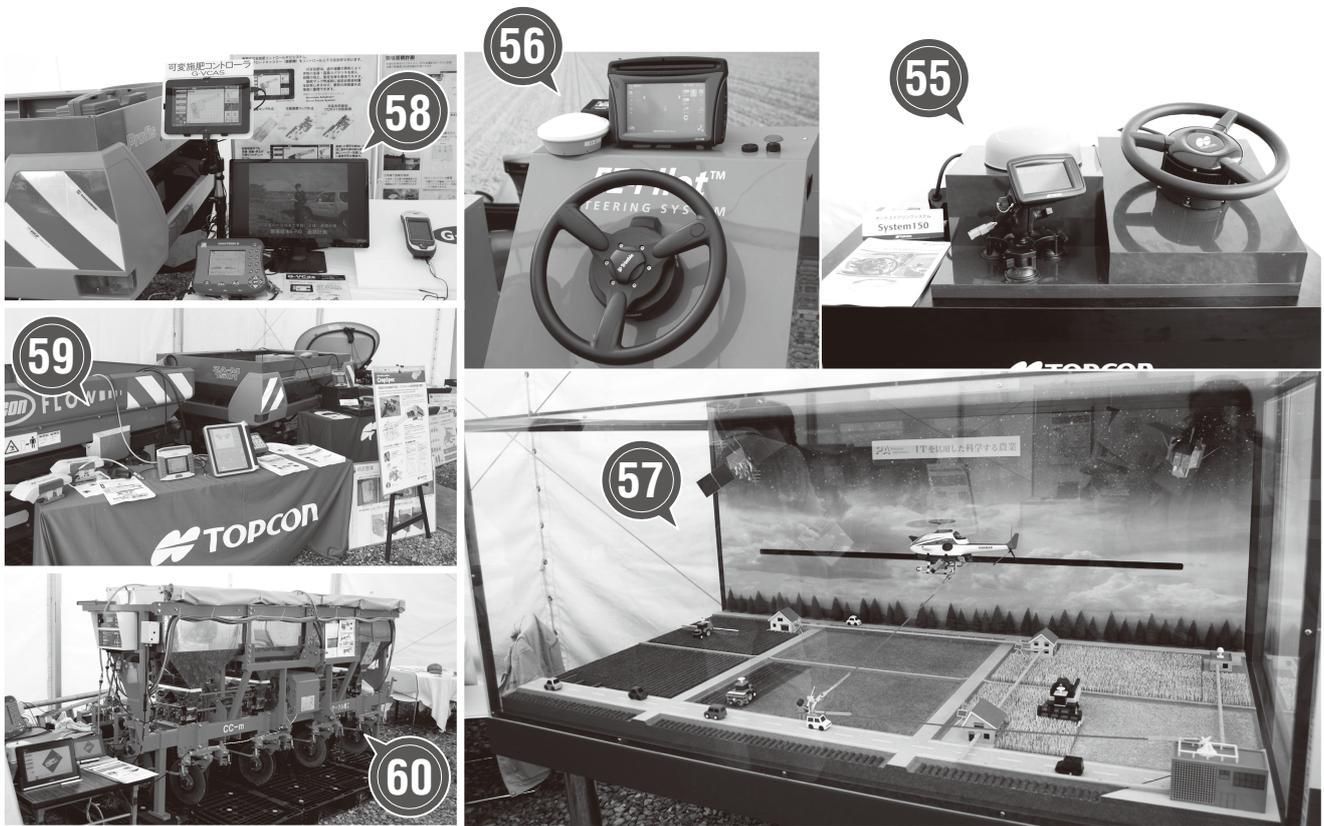
58 農業用オートステアリングシステムSystem150 (株トプコン) 59 自動操舵補助システムEz-Pilot (株ニコン・トリンプル) いずれもガイダンスが普及し、傾斜圃場や区画の大きい圃場ではRTK-GPSと連動した自動操舵システムの導入も進みつつある 57 約10年前に製作された「精密農業」のイメージ模型 (株ズコーシャ) 58 可変施肥システムG-VCas (株システムサプライ) 59 生育センサCropSpecと連動する可変施肥システム (株トプコン) 60 衛星画像による土壌マップに従って可変施肥システム (株ズコーシャ) と対応する施肥機 (サークル機工株)
