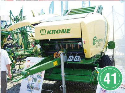
41 クローネ コンプリマF155XC (キセキ北海道(株))：ドイツ製のロールベラー。半固定のベールチャンパーとベールラッパーのコンビネーションながら、機体は短くてコンパクト。ベールサイズは直径1.25～1.5m
