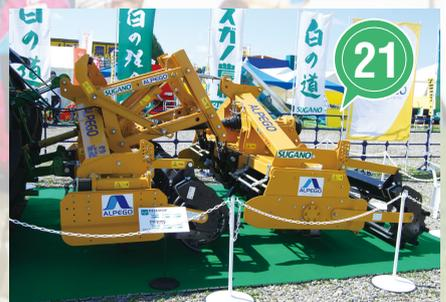
バーチカルハローとロータリーのコンビネーション(サガノ農機株)：砕土・鎮圧、播種床造成を一度に行なえる複合作業体系(参考出品)。作業幅は3mだが、このコンビネーションには、250馬力以上のトラクターが必要のため導入できる圃場は限られそうだ
