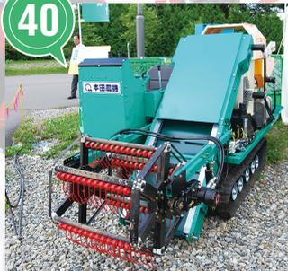
40 英豆収穫機HS-600 (本田農機工業(株))：リール回転によって枝豆などを立毛状態で収穫する機械を開発した(参考出品)。これまでは収穫後に脱英を行なう装置だったが、足回りに後駆動のクローラを装着し自走式に。収穫能力は1時間当たり3.3～4.29a(畝幅0.66mの場合)
