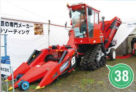
38 BOURGOIN GR10 (伊藤忠メンテナンス(株))：フランス製のコンハーベスター。トウモロコシの雌穂のみを茎からもぎ取って収穫するタイプで、フォレージハーベスターの粉碎機能もコンバインの脱穀機能もない。自走式2条刈り。収穫物はポテトハーベスターやビートハーベスターと同じくタンクをひっくり返してトラックに積み込む
