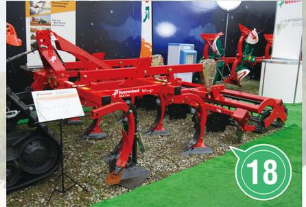
クバナンドのスタブルカルチベータ(株式会社クボタ)：粗耕による残渣物の混和と排水性、乾きの促進に効果的な作業機。前方のエア付きのティン(爪)と後方の2方向に配置されたディスクで表層混和し、カゴローラーで鎮圧する。作業幅は2.5～5.0m。作業速度は時速8kmが目安。麦稈や稲ワラを処理し、播種床をつくる作業に最適
