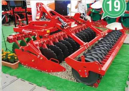
クバナンドのコンパクトディスクハロー(株式会社クボタ)：表層混和に最適だが、スタブルカルチに比べて整地効果を発揮する。作業幅は3.0～6.0m。時速12kmの高速作業が可能。その他、ブラウの展示もあり、本格的にクバナンドの作業機を展開する意気込みが感じられた
