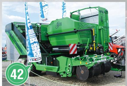
42 AVR Sprit6200 (東洋農機(株))：同社が輸入販売を予定しているベルギー製の2畦オフセットポテトハーベスター。食用、加工用、種子用いずれの用途にも利用できる。機体は全長9,830×全幅3,300×全高3,800mm。重量は8,370kg。90PS以上のトラクターでけん引できる。自動畦合わせを導入し、ピッキングテーブルは最大6人まで作業できる
