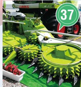
37 クラス JAGUAR (エム・エス・ケー農業機械(株))：フォレージハーベスターの最新機種。収穫しながら粉碎するため、ホールクroppサイレージづくりに最適。コーンクラッカーは2本のツースローラーが異なる速度で回転し、種子を破砕するオプション部品
