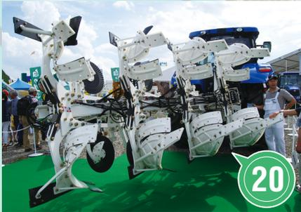
デジタルブラウ(サガノ農機株)：耕幅や耕深などをディスプレイに入力するだけでブラウのセッティングが行なえる機能を搭載したモデルを参考出品した。一度セッティングした設定情報は記録されるので、毎回入力する手間もかからない。面倒なセッティングを自動化できればと願ってきたオペレーターの期待に応える一台になるか
