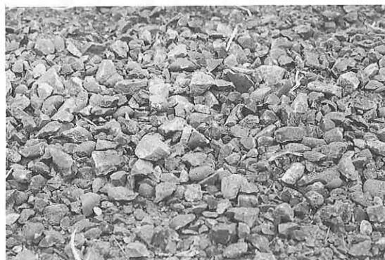
写真9) ストーンクラッシャによる石礫の破碎状況一その2
