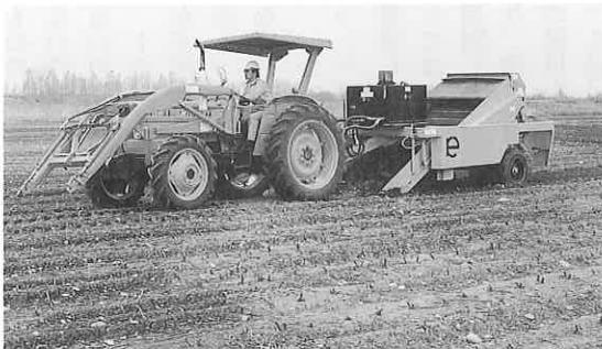
写真7) ストーンクラッシャ (ローラタイプ・イギリス製)
