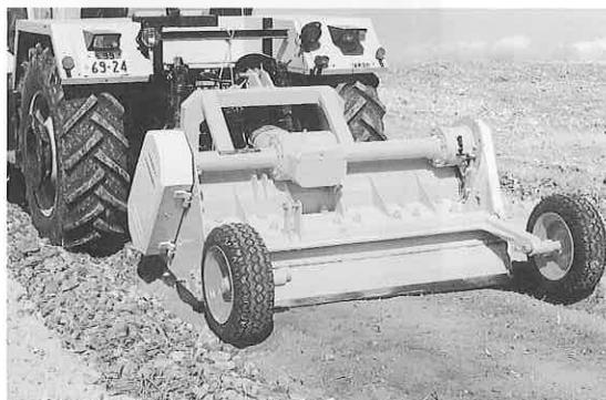
写真10 ストーンクラッシャ (ハンマタイプ・ドイツ製)
