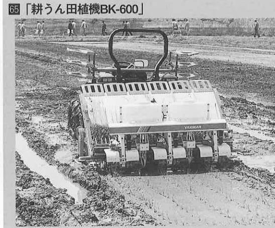
標準耕深80mmの専用ロータリで耕うん・碎土しながら同時に植付部(6条)で移植・施肥をおこなう。あらかじめの耕起・代かきが不要なので省力化・面積拡大が図れる。トラクタ(RS30VU、30ps)に装着するアタッチメントタイプ。耕起作業幅1,740mm。希望小売価格4,210,000円(トラクタを含む)。
