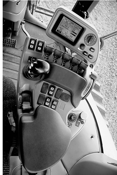
AGCO社「チャレンジャー」クローラトラクタの運転席右側にあるTMCディスプレイは、オプティコシステムで、トガイドシステムとつながる。
