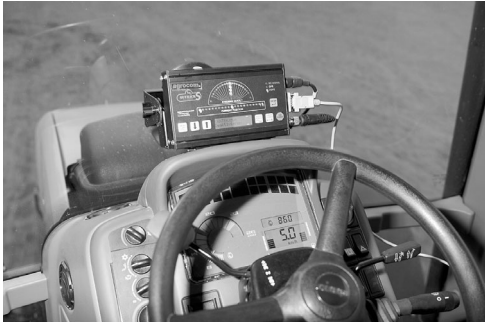
オートバック社の「E-ドライブ」は、性能に定評のあるオートバックS進路誘導システムと同じディスプレイを利用している。
