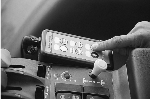
トリンブル社の「オートパイロット」は、タッチパッドによって作動させる。
