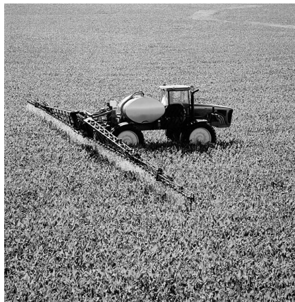
ジョンディア社製「4920」の登場は、自走式ブームスプレーヤ大型化の呼び水になった。
